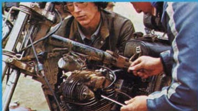
vamos a prescindir de él! Josep M.\* golpea los discos de manera que queden completamente fijos entre sí con lo cual el motor queda conectado continuamente a la tracción, la moto, de esta manera, irá a partir de ahora sin embrague durante más de 13.000 km, hasta el final de la expedición. La conducirá Josep M.\* y cambiará de marcha sin embrague, yo seré el encargado de empujarla cada vez que tenga que arrancar para poder meter la «primera» sin que se cale.
